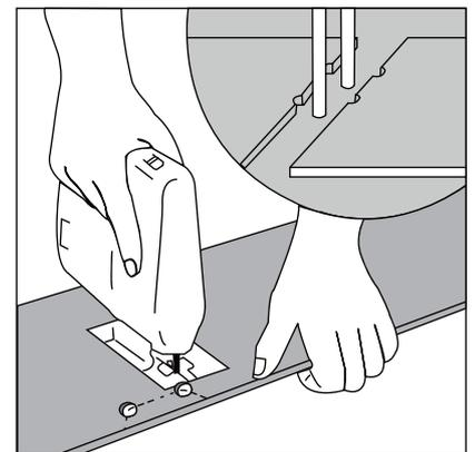
**9)** Orificios para tuberías: mida el diámetro de la tubería y realice un orificio que sea 7/8" (20 mm) más grande en el tablón. Corte el tablón en dos piezas perpendicularmente al largo y divida en dos el orificio perforado previamente. Luego, coloque las dos piezas en su lugar alrededor de la tubería.
