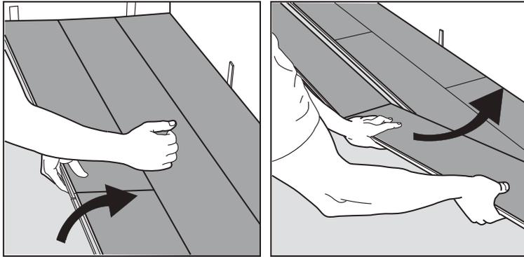
Para separar toda la fila levántela delicadamente en ángulo. Para separar uniones de los extremos de tabloncillos individuales en una misma fila, déjelos acostados en el piso y deslícelos mientras los separa. Si los tabloncillos no se separan fácilmente, puede levantar levemente los tabloncillos (ángulo de 5°) cuando los desliza y los separa.
