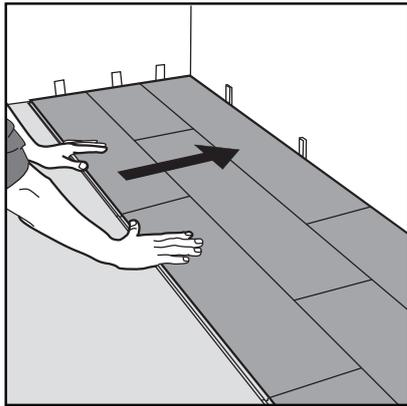
**7)** Después de 2-3 filas. Ajuste la distancia con la pared frontal, deje un espacio para expansión de 1/2" (10 mm). Siempre asegúrese de que las juntas de los extremos estén colocadas con un diseño trabado de al menos 12" (30 cm) de una fila a la siguiente.
