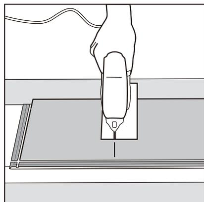
④ Si corta con una sierra caladora, la superficie laminada debe mirar hacia abajo. Si corta con un serrucho, la superficie laminada debe mirar hacia arriba.
