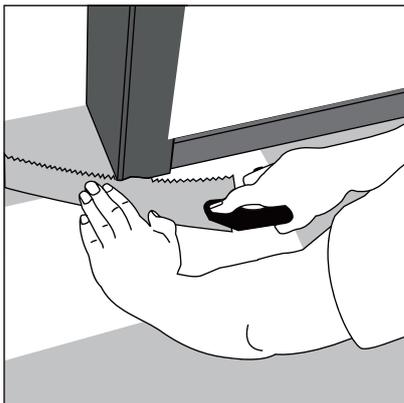
**10)** Molduras y zócalos de puertas: coloque un tablón (con el lado decorativo hacia abajo) junto a la moldura de la puerta como se muestra en la figura. Luego, deslice el tablón debajo de la moldura.
