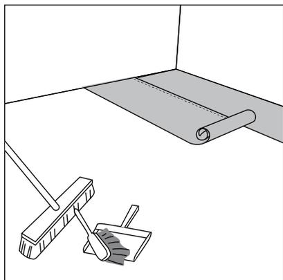
① Después de limpiar muy bien el contrapiso antes de instalación. Si instala sobre subsuelo de concreto, una lámina de polietileno de como mínimo 6 mil barrera de la humedad. Coloque la base de barrera de humedad en la misma dirección que los tablonces del piso. La base de piso debe estar unida sin superponerse de lado a lado. Coloque cinta en las uniones.
